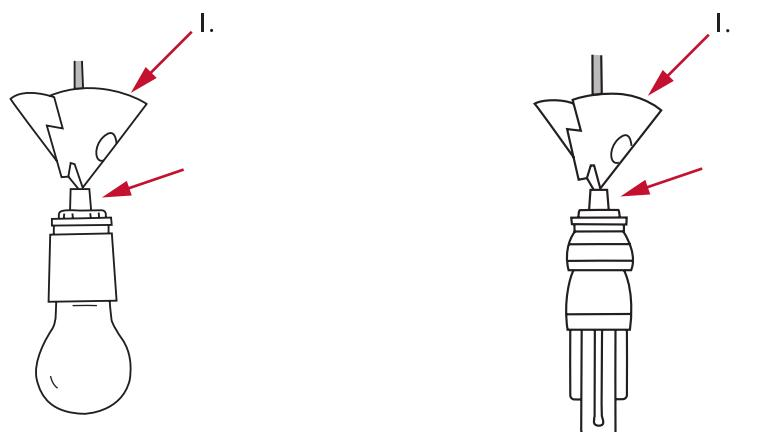
Das erste Aufhängungselement um das Kabel herum "zusammenknipsen" – die Spitze nach unten. **WICHTIG!** Zwischen der Fassung und dem Aufhängungselement muss ein Abstand sein. Deshalb **MUSS** der beiliegende Nippel gemäß der Abbildung am Kabel montiert werden.
