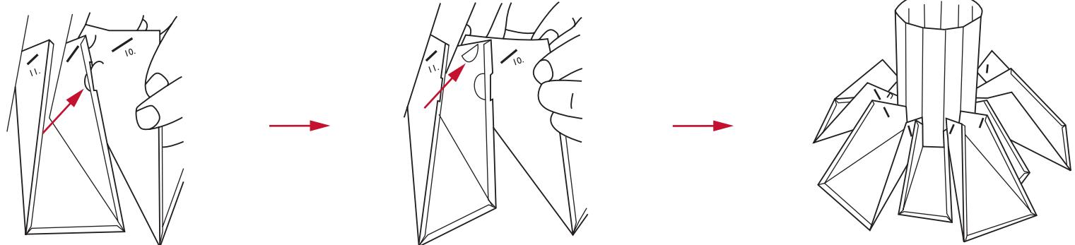
如图所示，将六个标有'10'的元件固定在标有'11'的元件上。
