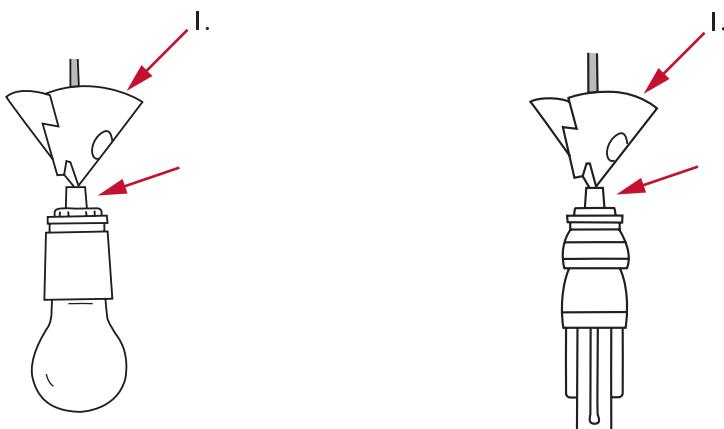
Det første ophængselement "knipses" sammen om ledningen – med spidsen nedad. **VIGTIGT!** Der skal være afstand mellem fatning og ophængselement. Derfor **SKAL** vedlagte nippel monteres på ledningen, som vist på tegningen.
