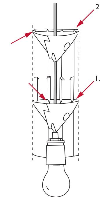
Introdurre la lampadina e il portalam-pada nell'elemento base, e premere il primo elemento di sospensione verso il basso davanti alle linguette. Montare quindi il secondo elemento di sospensione attorno al cavo di alimentazione, con il vertice rivolto verso il basso. Introdurre nell'elemento base.
