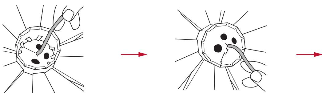
Birne und Fassung in den Sockel hinabsenken und das erste Aufhängungselement an den "Lappen" vorbei hinunterdrücken. Das zweite Aufhängungselement mit der Spitze nach unten am Kabel montieren und es als Führung in den Sockel absenken.
