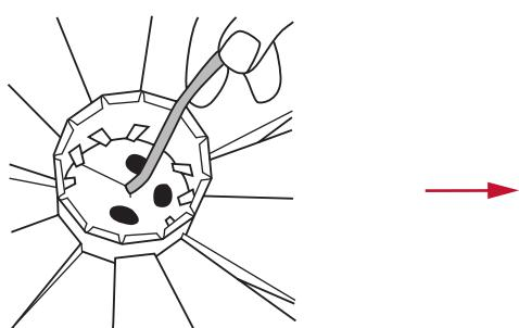
Introducir la bombilla y el portalámparas en el soporte, y presionar la primera pieza suspensora pasando por las pestañas. Ensamblar la segunda pieza suspensora en el cable con el pico hacia abajo e introducirla dentro del soporte como guía.
