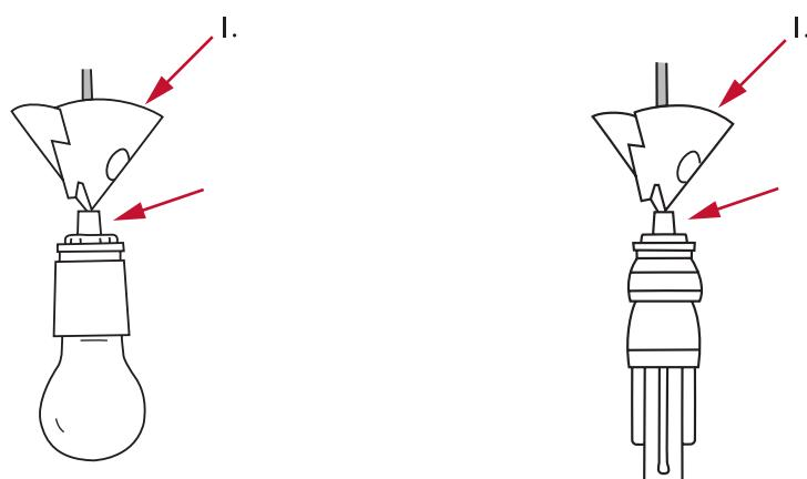
« Enrouler » le premier élément de suspension autour du câble, en orientant la pointe vers le bas. **ATTENTION!** Il est impératif de conserver un certain écart entre la douille et l'élément de suspension. Le raccord livré **DOIT** donc être monté sur le câble, comme indiqué sur le croquis.
