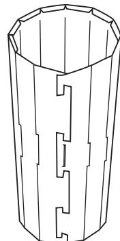
Ripiegare su se stesso l'elemento di base formando un cilindro a dodici lati. L'estremità con il bordo ripiegato all'interno deve essere rivolta verso l'alto.
