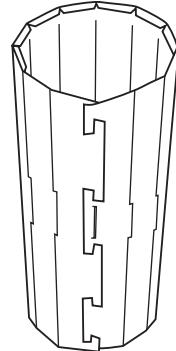
将中心元件卡在一起，形成一个12面的柱体。
