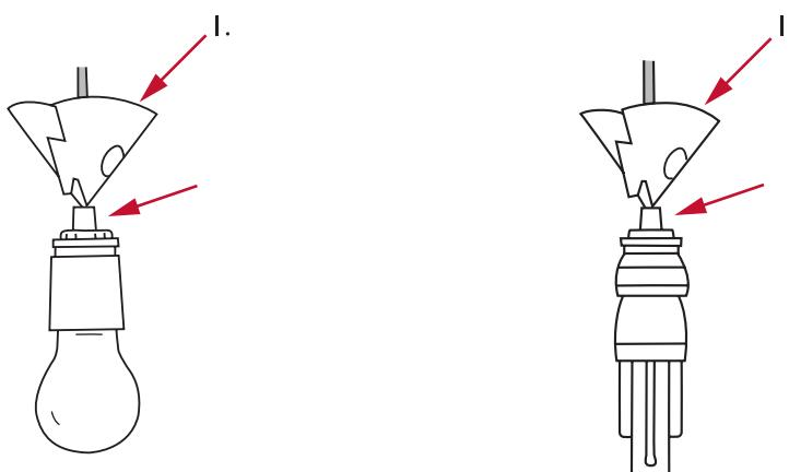
Acoplar la primera pieza suspensora alrededor del cable con el pico hacia abajo. **¡IMPORTANTE!** Hay que dejar un espacio entre el portalámparas y la pieza. Es absolutamente necesario montar la boquilla suministrada en el cable como se muestra en la ilustración.
