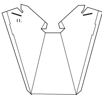
De 6 elementen met opschrift 'II' uit de verpakking nemen. Overbodig materiaal in de twee sleuven verwijderen.
