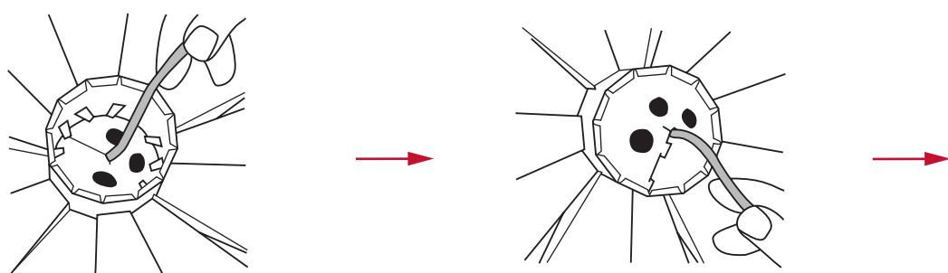
De lamp en de fitting in de sokkel laten zakken en het eerste ophangelement naar beneden, langs de 'vaandels' duwen. Het tweede ophangelement op het snoer monteren met de punt naar beneden. In de sokkel laten zakken als stuur.
