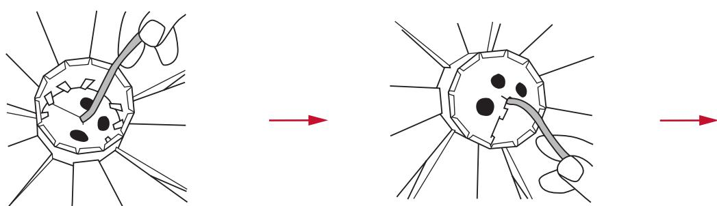
Descendre l'ampoule et la douille dans le socle et faire passer le première élément de suspension au-delà des « onglets ». Monter le second élément de suspension sur le câble en orientant la pointe vers le bas. Descendre l'élément dans le socle où il servira de pièce de guidage.
