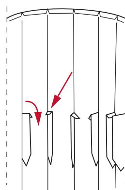
De vaandels van de elementen in de gleuven van de sokkel steken – en de uiteinden aan de binnenkant rechtop zetten.
