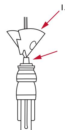
Ripiegare su se stesso il primo elemento di sospensione attorno al cavo di alimentazione, con il vertice rivolto verso il basso. **IMPORTANTE!** Il portalam-pada e l'elemento di sospensione devono essere distanziati. È pertanto **NECESSARIO** montare sul cavo il distanziale in dotazione come illustrato nella figura.
