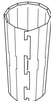
Enrollar y enganchar el soporte formando un cilindro de 12 lados con la parte de las pestañas hacia arriba.
