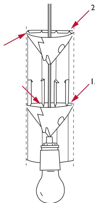
電球とねじこみ口を土台の中に下ろし、最初の吊り下げエレメントを“翼部”をバイパスして押し込んでください。
