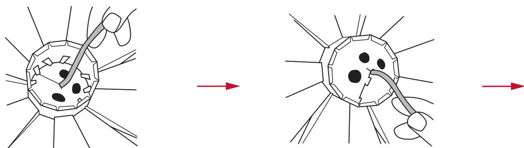
Pære og fatning sænkes ned i sokkel, og første ophængningselement presses ned forbi "fanerne". Det andet ophængningselement samles på ledningen med spidsen nedad. Sænkes ned i soklen som styr.
