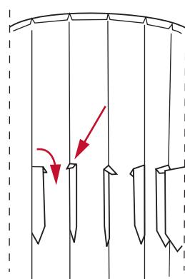
Die Lappen der Bauteile in die Sockelschlitzte stecken
