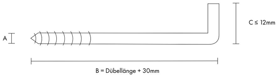
Die Maße A und B variieren je nach Dübelgrößen. / Length of A and B vary, depending on dowel.
